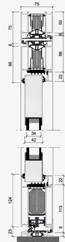
Vertikaler Schnitt zu KÖSTER Advance 75 als Glasfalz. Gezeigt werden die Bodenschwelle und der verstellbare Bodenabschluss, der leichte Toleranzen ausgleicht.
