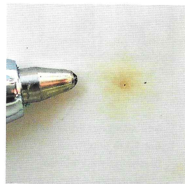
o.: Oxidierender Metallspan von einem gelben Hof umgeben. Die Kugelschreiberspitze macht die Größenordnung sichtbar.
